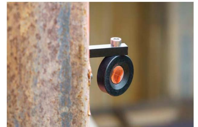
Überwachungspunkt, montiert an Spundwand
